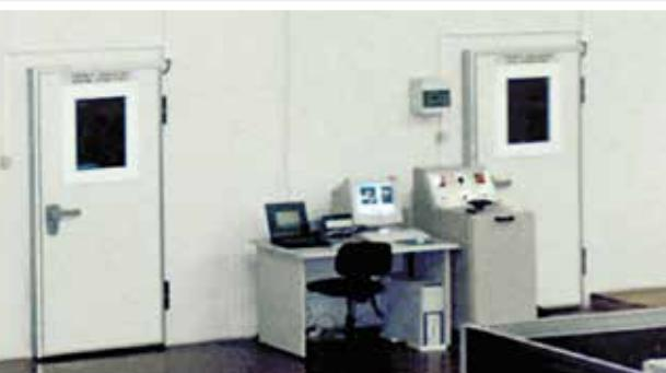
Sıcaklık, nem ve hava hızının hassas olarak kontrol edildiği (PLC VE PC ile) özel olarak tasarlanmış odalardır.
